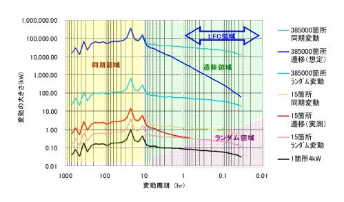
同期変動からランダム変動に移る「遷移仮説」に基づき、 北陸地域における PV 大量普及時の出力変動を想定した一例
