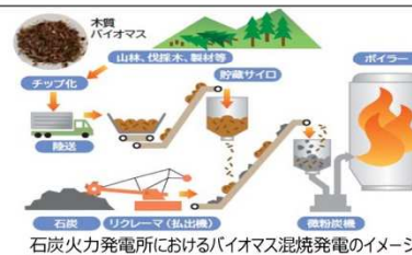
石炭火力発電所におけるバイオマス混焼発電のイメージ
