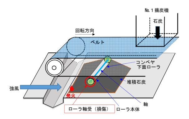
七尾大田火力発電所 火災発生箇所廻り 石炭コンベヤ概略図
