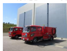
可搬型低圧注水ポンプの配備
